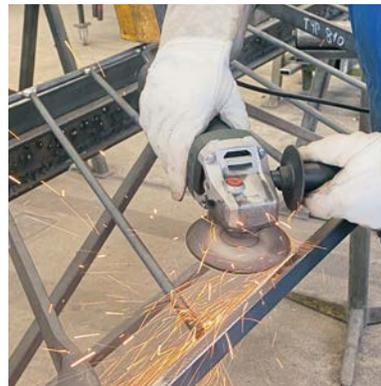
Les cordons de soudure sont ébavurés, poncés avec un disque fibres 1187C Cubitron 3.
