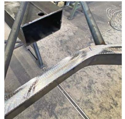
Les garde-corps sont parfaitement et proprement poncés.
