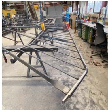
Les éléments en acier sont découpés, ajustés, soudés, prêts à être poncés.
