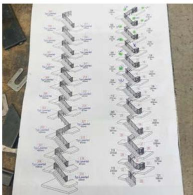
Der Plan zeigt die komplexe und aufwendige Konstruktion des Treppengeländers.
