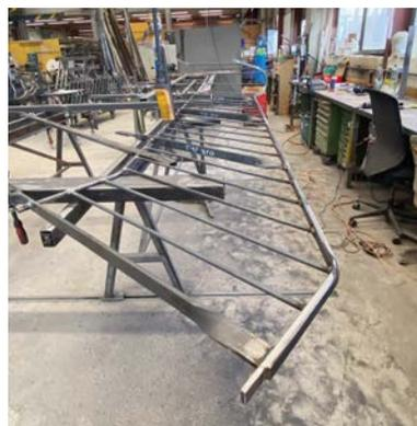
Das Stahlelement liegt zugeschnitten, geformt und geschweisst zum Schleifen bereit.
