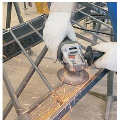
Schweissnähte werden mit der 3M 1187C Cubitron 3 Fiberscheibe geschliffen.
